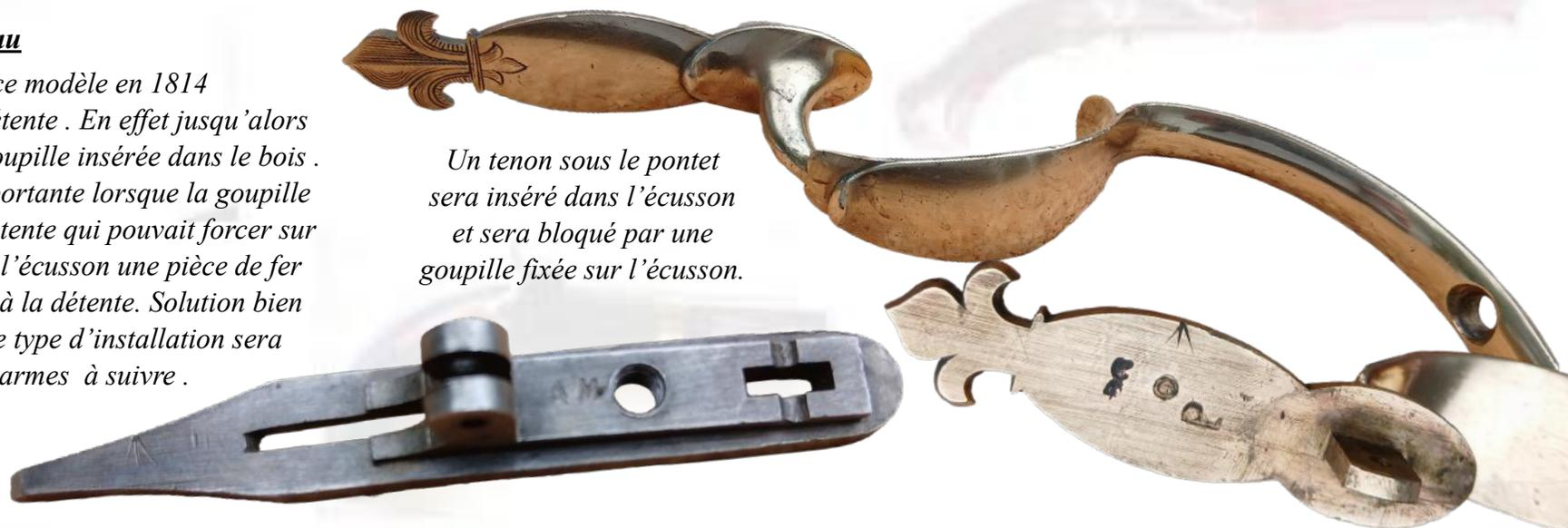
*Un tenon sous le pontet sera inséré dans l'écusson et sera bloqué par une goupille fixée sur l'écusson.*
