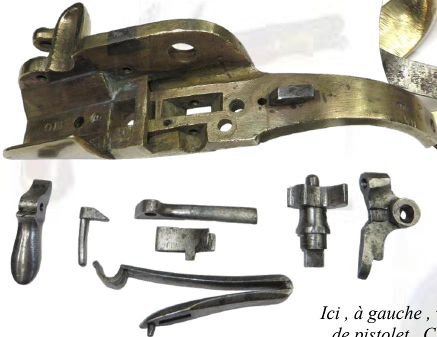
*Ici , à gauche , vue de l'ensemble des pièces qui constituent le mécanisme de ce modèle de pistolet . C'est nouveau à l'époque mais ce type de platine ne perdurera pas dans l'armée. Le nombre de pièces à l'avantage d'être moindre que dans la platine classique .*
