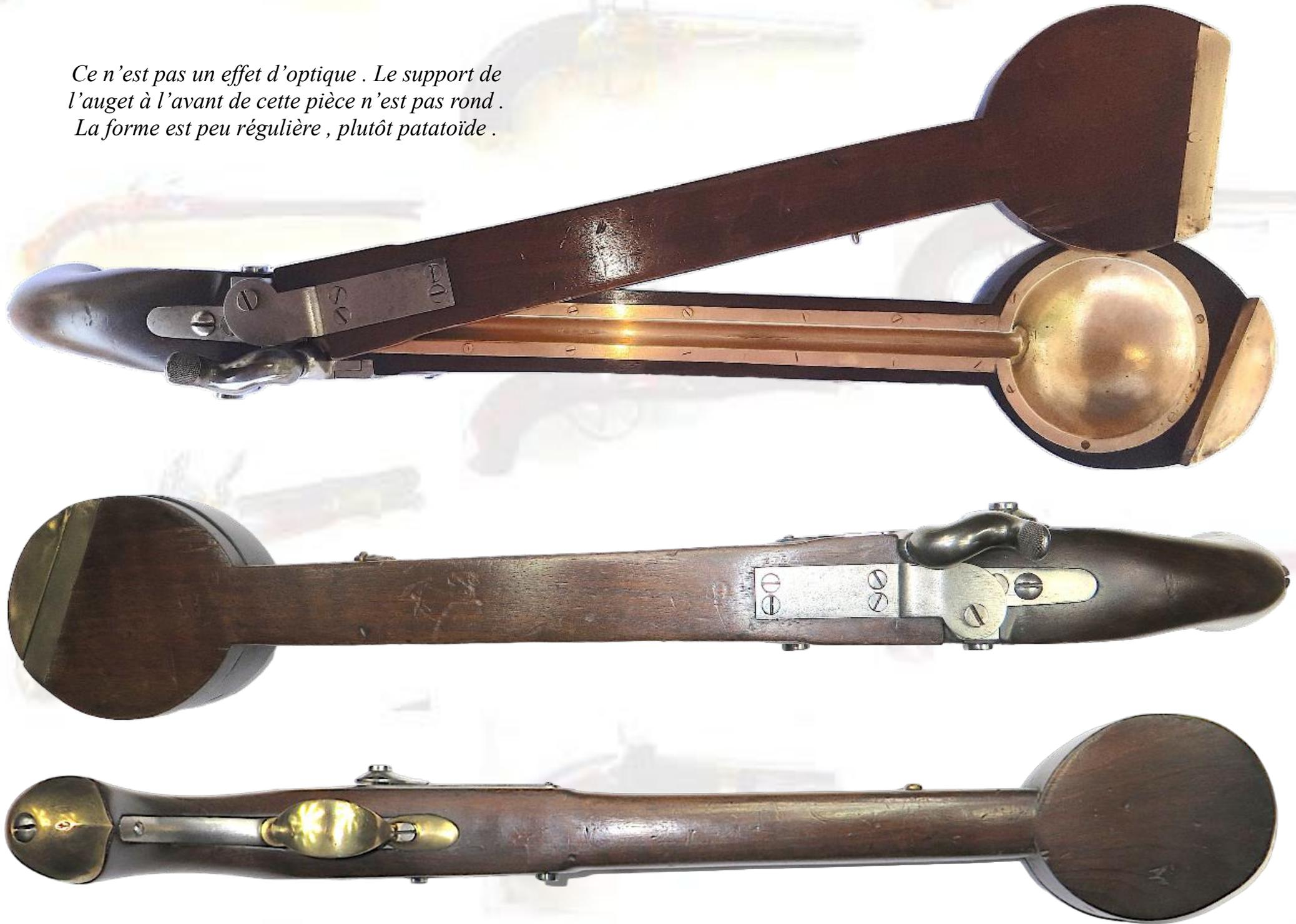
*Sur ce détail de la platine on voit bien qu'il s'agit d'une classique platine de pistolet 1816. On y a installé une pièce spécialement adaptée à l'emplacement du bassinet et destinée à recevoir la percussion du chien type 1822T.*
